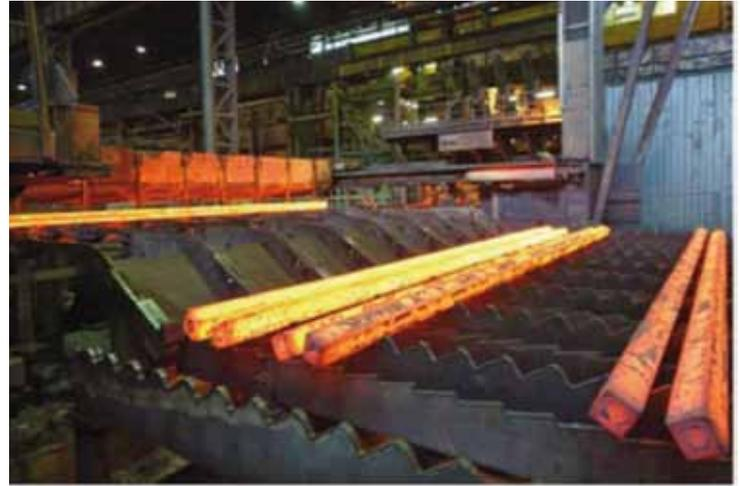
riscaldato fino a 1600 gradi fondendo. Per la produzione di una tonnellata di acciaio vengono consumati circa 700 kWh di corrente e considerevoli quantità di gas metano e di ossigeno.
